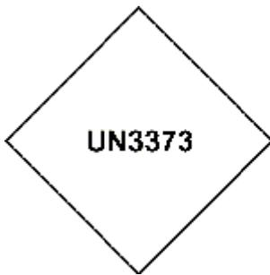
lettres, chiffres et traits : lettres et chiffres d'une hauteur d'au moins 6 mm et trait d'une largeur d'au moins 2 mm
