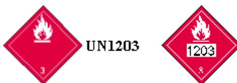
*L'illustration du numéro UN à droite de la plaque n'est qu'un exemple et n'indique pas le placement obligatoire. Une étiquette enveloppante peut être utilisée sur une bouteille à gaz.*
